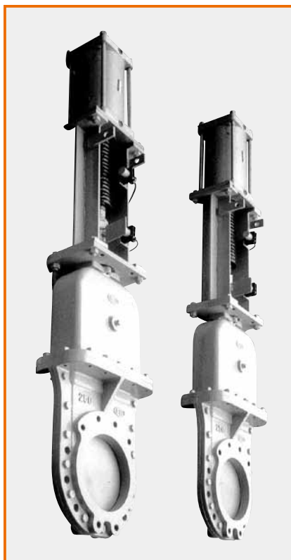
■カバー付ナイフゲートバルブ エアシリンダー操作 2重グランド構造 ジャバラ付 S-8006
